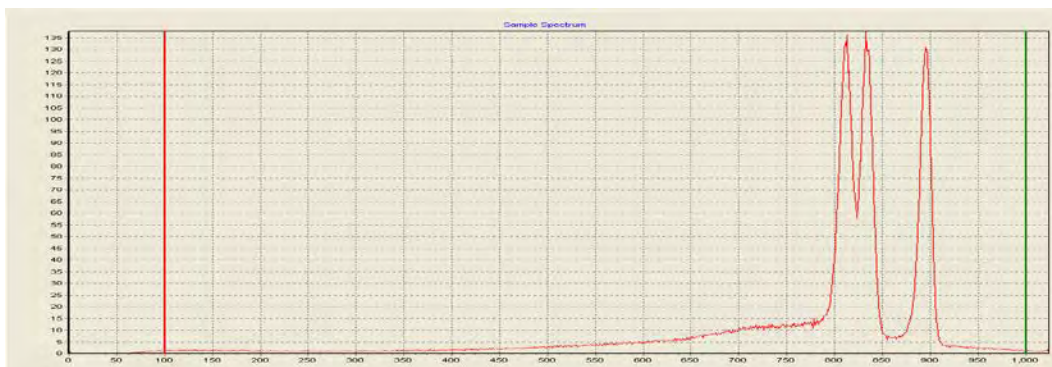
Figura 6 – Spettro energetico acquisito dall'analizzatore Quantulus.
